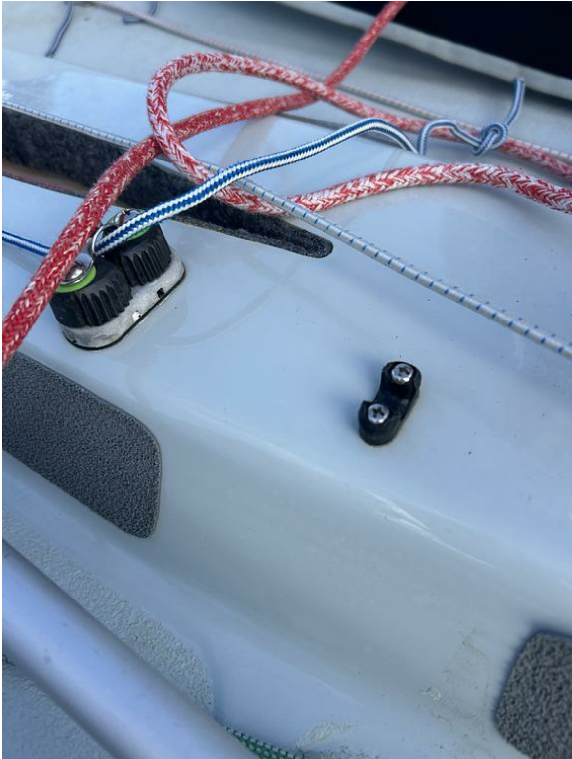
カムの後ろに着いている部品が破損している
